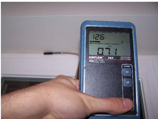
Figura 12 camera da letto infiltrazione modesta
